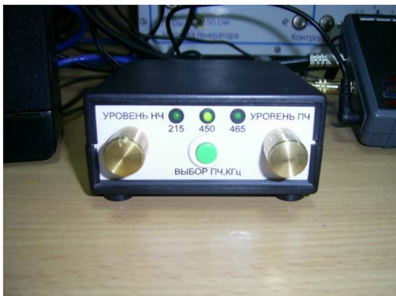
Рис. 1. Внешний вид приставки – преобразователя частоты.
