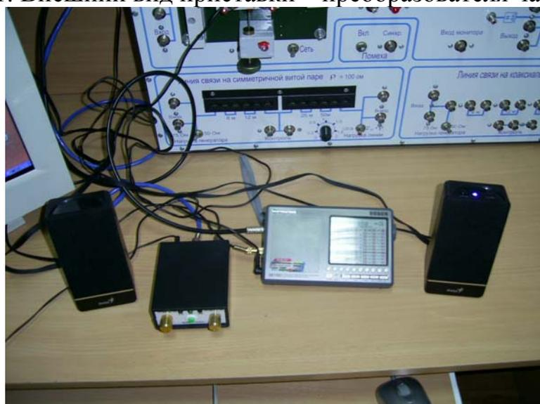
Рис. 3. Подключение приставки к радиоприемнику DEGEN DE 1103
