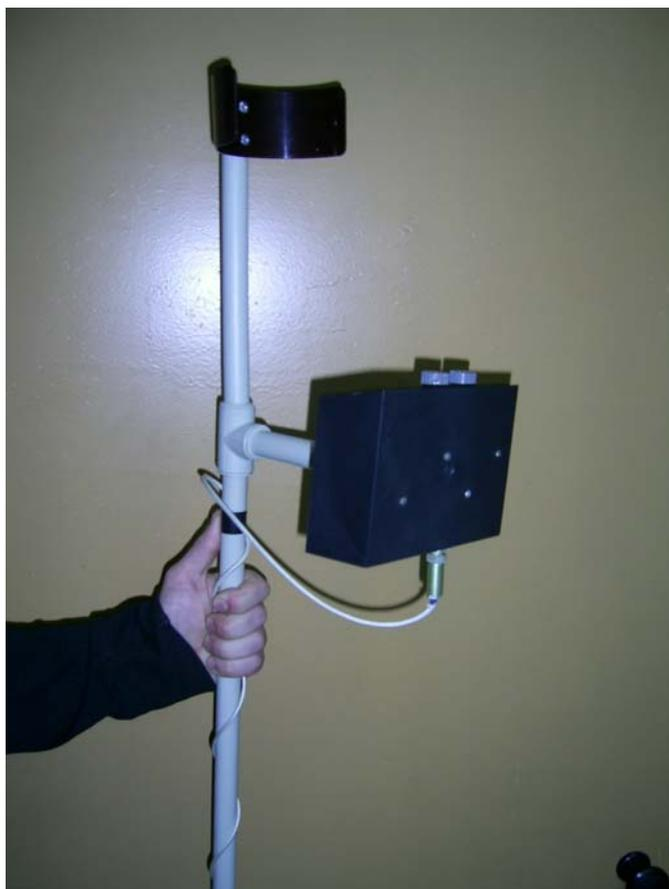
Рис. 5. Вид несущей штанги с устройством фиксации локтя
