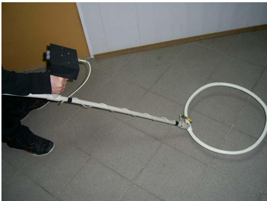
Рис.2. Положение прибора в режиме «Металлоискатель»
