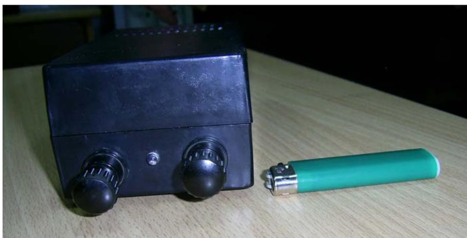
Рис 3. Вид передней панели генератора ВЧ ЧМ
