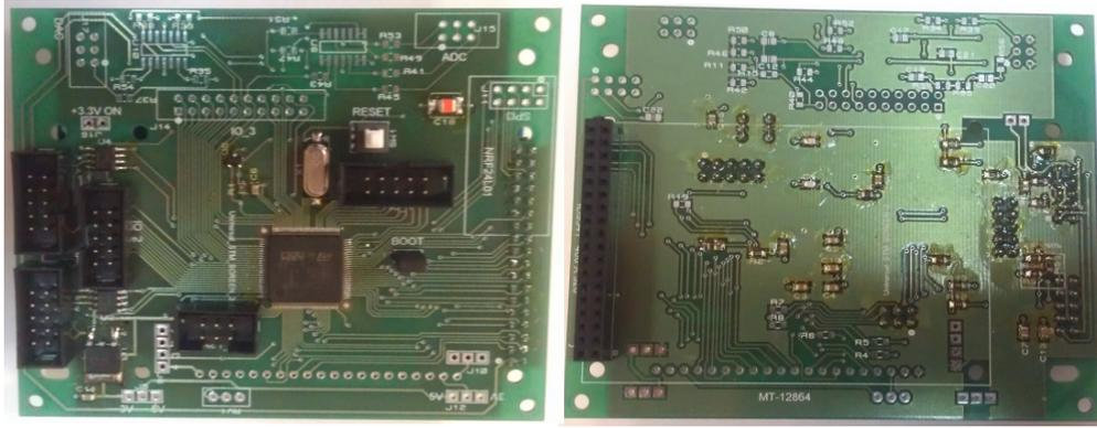
Рис. 3 – Плата микропроцессорной системы управления
