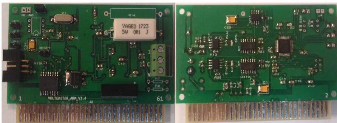
Рис. 2 – Плата измерительных трансформаторов
